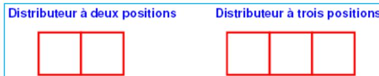
A un instant donné, seule une des cases est utilisée. On ne câble donc les tuyaux que d'un côté.
